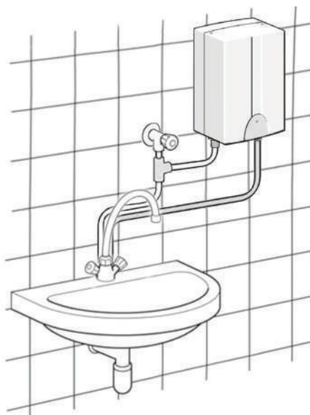
Installation Tronic 1000 B sur évier
